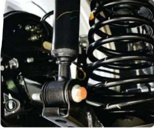
تستخدم سبيكة الصلب مع الفانديوم في صناعة زبركات السيارات
