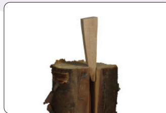
شكل (8) يُستخدم في تغيير اتجاه القوة المؤثرة
