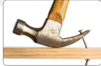
شكل (2) يُستخدم الشاكوش المخلبي في مضاعفة القوة عند نزع مسمار مثبت في لوح خشبي
