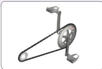
شكل (9) تُستخدم في نقل الحركة وتغيير السرعة كما في الدراجات
