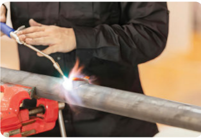
شكل (12) يُستخدم لهب الأكسجين أسيتيلين في قطع المعادن
