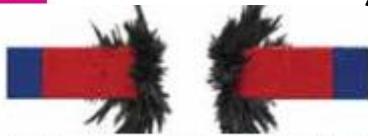
شكل (٥): الأقطاب المغناطيسية المتماثلة تتنافر
