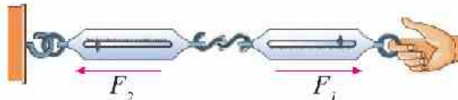
Fig. (39): la lecture du premier dynamomètre est égale à la lecture du deuxième dynamomètre.
