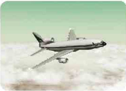
Fig. (10) La composante horizontale de la force portance de l'avion agit comme une force centripète
